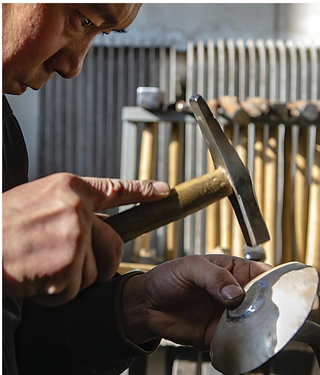
利用银器的延展性反复敲打勾推,使其定型,在锤揲器物形制或纹样时还需要衬以事先预制好的坚硬底模,使得金银片在锤揲时按底模成型,这种方法也被称为“模冲”,尤其是对于造型要求准确的纹样,多采用此法。使用勾技属于慢工出细活,掌握这项技能的艺人很少,杨德贵加工的银杯底座就是一锤一锤的勾出来的,锻打锤揲是金银器成型工艺和装饰工艺常用的方法之一。
