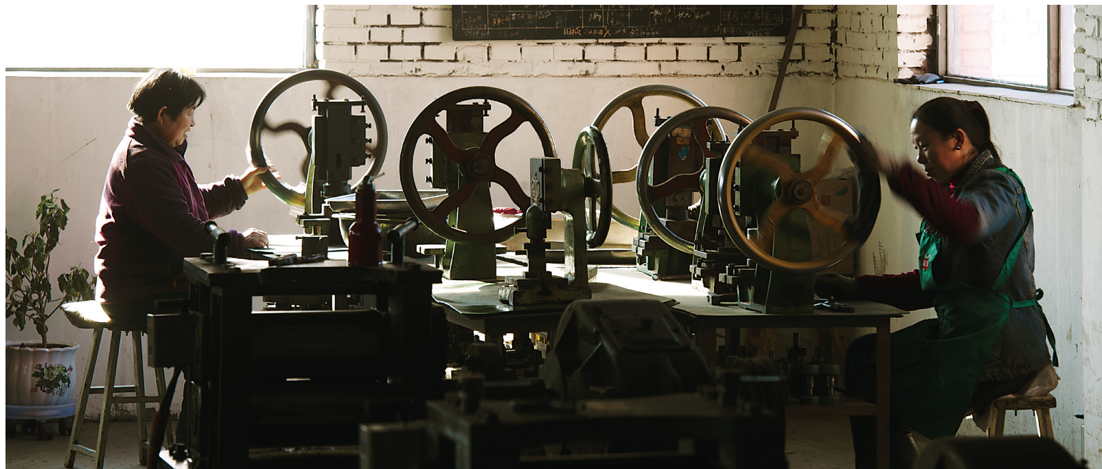
压模,把银片压出基本轮廓,然后换模具进行二次压模,然后裁掉多余的银片,银饰的一半就已经完成。
