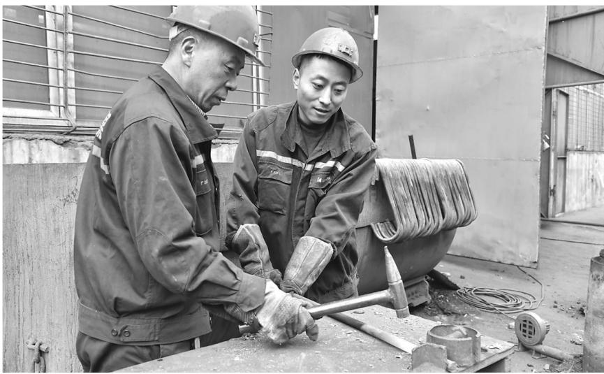
1月25日,在山西焦煤汾西矿业高阳煤矸石综合利用中心,两名职工正在利用井下回收的废旧钻杆,为井下队锻造悬挂水管、电缆等设备的“C”型钢。
