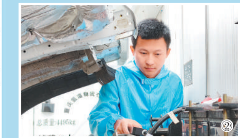
远景能源有限公司供图 图②:蔡开南检查氢能汽车氢气管道密封情况。
