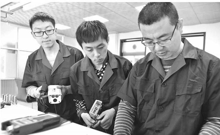
山西焦煤汾西矿业高阳煤矿依托“王斌俊机电创新工作室”“姬展鸿网络信息化创新工作室”“研究生工作站”制定人才激励政策,重视创新成果,激发全体职工的创新热情,推动矿井科学可持续发展。图为高阳煤矿“姬展鸿网络信息化创新工作室”职工正在维修摄像监控和KTK113(B)矿用本质型广播分站设备。
