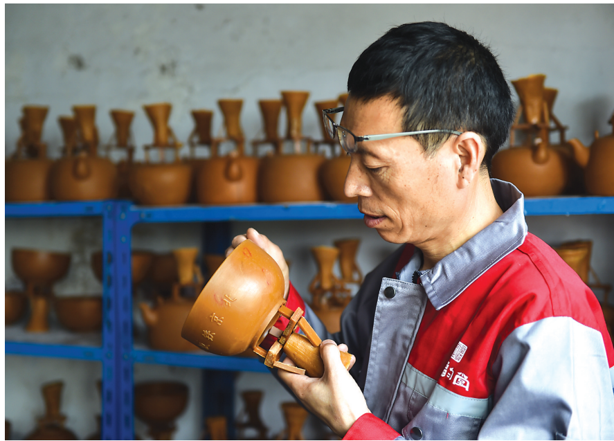
7月9日,在晋城市晋韵堂老铁货开发有限公司的工作间内,郭忠平在查看蜡制的壶身模具。
