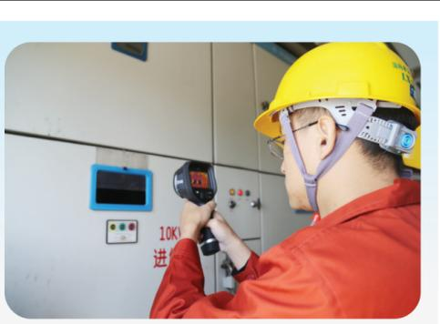
孝义市供电公司变电站巡检员在35KV楼西变电站对站内设备进行红外测温。
