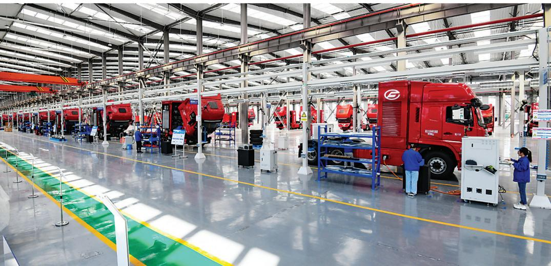
在吕梁经济技术开发区新材料园区美锦氢能商用车整车生产线上,曾经拉煤的大排量柴油型卡车经过氢能燃料电池重卡底盘总成装配、改制、检测、调试后,摇身一变成了新能源重卡。美锦年产2万台氢能商用车整车生产项目总投资18亿元,一期年产5000台氢能商用车生产线和生产厂房、联合站房、油化库等配套设施项目已投产运行,所生产的氢能燃料电池重卡正在进行下线前的最后调试。 记者 刘光亮 摄
