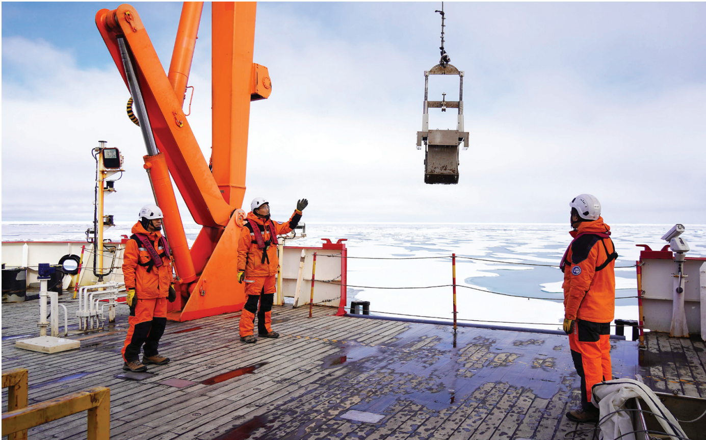
8月6日，在“雪龙2”号极地科考破冰船尾甲板，科考队员在进行箱式沉积物采样作业。
