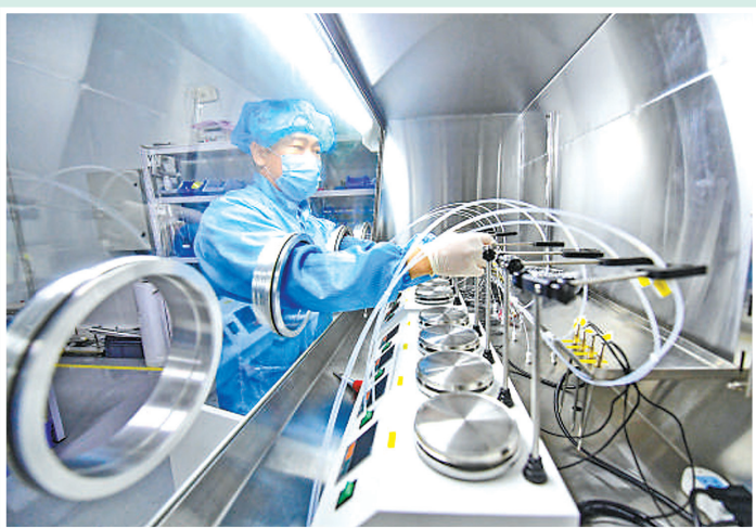
►辽宁沈阳,一家半导体设备有限公司的显示器行业专用蚀刻清洗机自动供液系统内,工作人员正进行非氧化高精度浓度配比装调调试。
