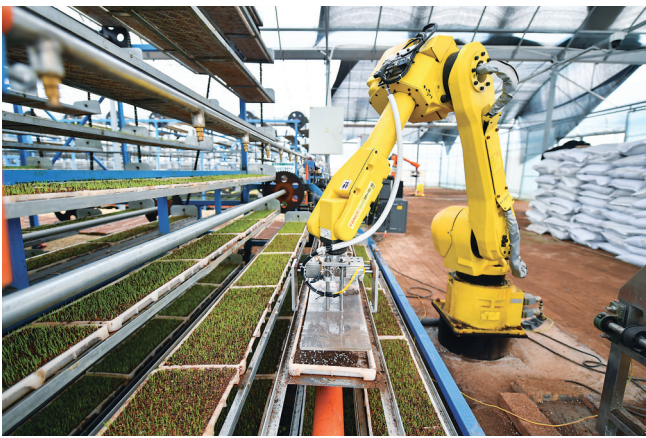
3月22日,在湘潭市雨湖区姜金镇青亭村的智能化育秧大棚内,智能机器人将水稻秧盘搬运到循环式智能育秧机上。春耕备耕时节,湖南省湘潭市雨湖区姜金镇的农业大户运用智能机器人智能水肥一体化系统等智能化设施进行水稻育秧和蔬菜育苗,提高劳动效率,助力增产增收。
