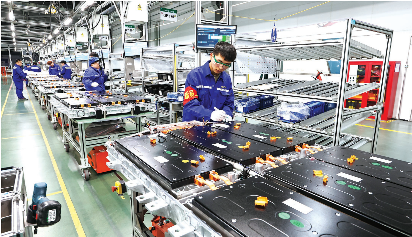
在上汽时代动力电池系统有限公司车间,工人在安装新能源汽车动力电池系统(2023年2月16日摄)。
