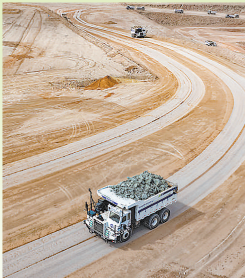
▲在新疆准东煤田五彩湾一号露天煤矿,中国能建普力公司应用新能源设备,引入无人驾驶矿卡近百台,每年可降低二氧化碳排放量近4000吨。 人民日报记者 张武军 摄
