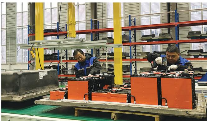
图为吕梁经开区新材料产业园区山西迪诺思新能源科技有限公司生产车间内,工人正将废旧动力电池进行拆解。
