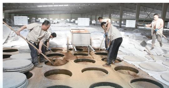
山西杏花汾河酒厂股份有限公司系西部门农工贸有限公司投资建设的村集体经济企业,位于杏花村酒业集中发展区内杏花镇安上村(火车站西),酒厂占地301亩,投资5.7亿元,设计产能10000吨,曲块5000吨,解决劳动就业570余人。含原粮储存、粉碎、制曲、成块、酿造及技术开发为一体,秉承清香型白酒的酿酒精髓,采用地缸发酵、人工装甑的传统工艺精心酿造,严格工艺操作,机械设备自动化、智能化,大大地减轻人力、劳力。
