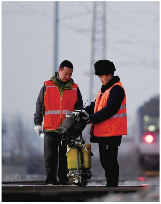
中国铁路太原局集团有限公司太原南工务段钢轨探伤工利用钢轨探伤仪对站场股道钢轨以及道岔进行伤损检测。
