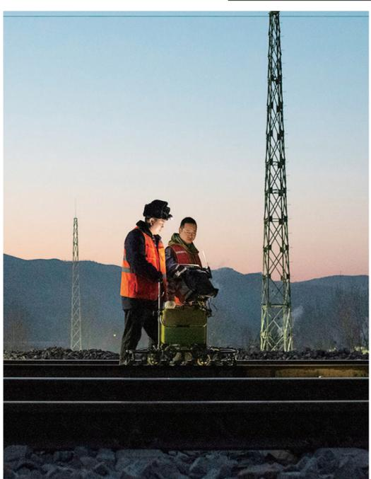
太原南工务段钢轨探伤工利用钢轨探伤仪对站场股道钢轨以及道岔进行伤损检测。
