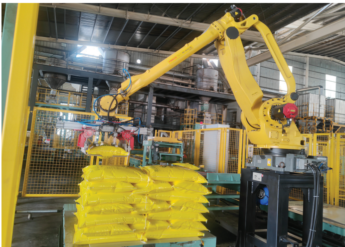
东锦肥业全自动码垛装置正在工作
