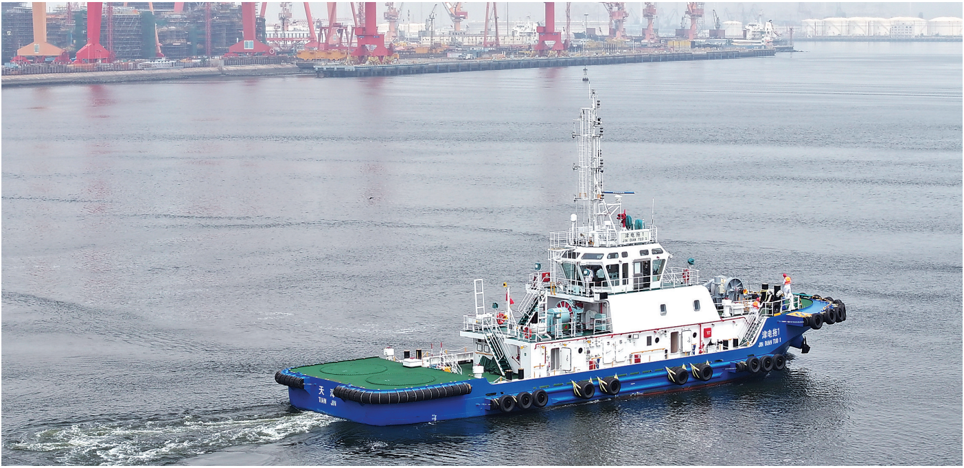
图为纯电动港作拖轮在水面航行。8月13日，由4艘纯电动港作拖轮组成的“绿色舰队”在中船天津码头鸣笛启航。据了解，这4艘拖轮组成了目前中国北方规模最大的纯电动拖轮船队，将主要用于在天津港水域协助各类船舶进出港和靠离码头作业。
