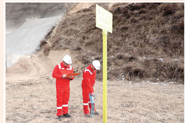
穿越枣林认真测量管道埋深数据。
