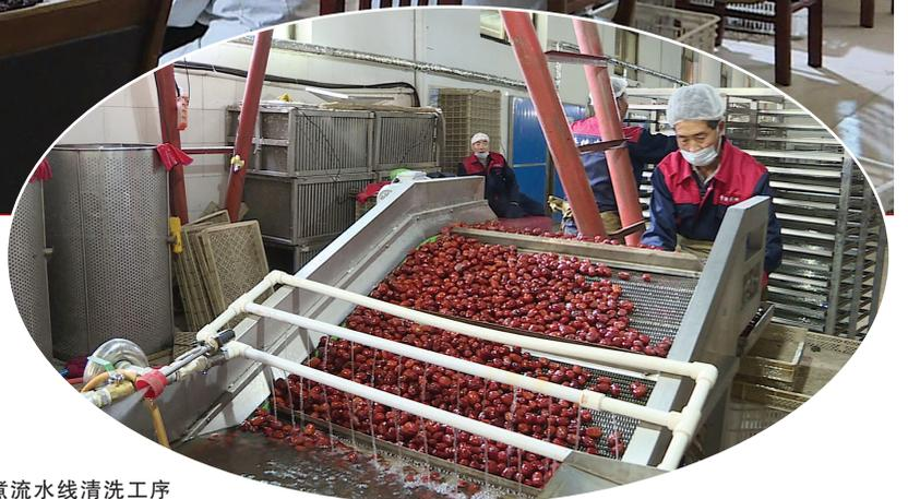
紫晶枣蒸煮流水线清洗工序
