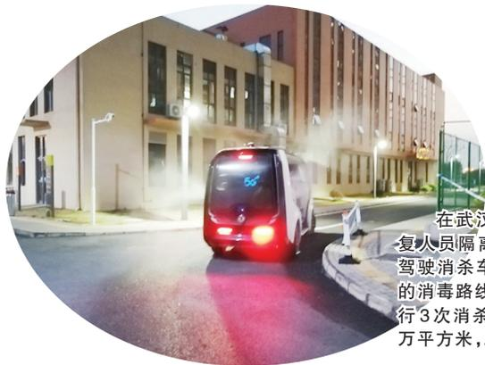
在武汉“经开智造2045·创新谷”康复人员隔离点,东风Sharing-VAN无人驾驶消杀车正在执行消毒杀菌工作。它的消毒路线总长1.1km,每天分早中晚执行3次消杀工作,单次消杀覆盖面积约1万平方米,工作效率远高于人工模式。
